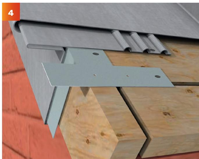
4 Pour les toitures cintrées (le rayon de courbure ne peut être inférieure à 3 m). Réaliser une découpe verticale du larmier tous les 1/10 de la valeur du rayon de courbure (p.ex. : rayon de courbure de la toiture 5 m => larmier découpé tous les 500 mm).
